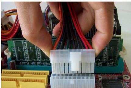
*Imagen 32: Instalación Conector ATX a la Mother Board*
