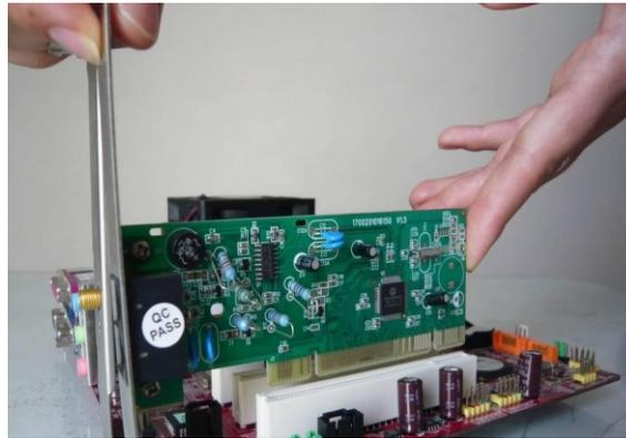
*Imagen 29: Instalación Tarjetas de Expansión*
