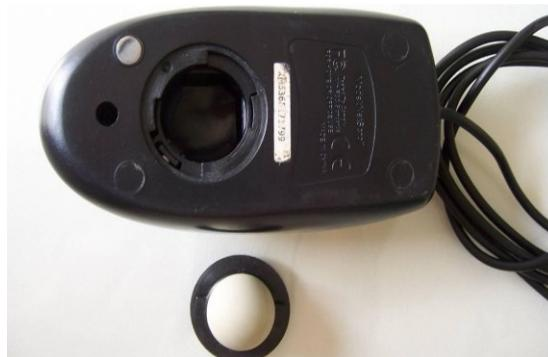
*Imagen 19: Ratón Mecánico (Parte Inferior y rodillos)*
