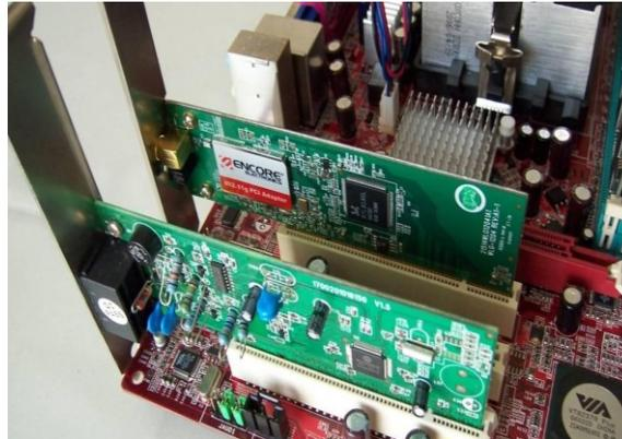
*Imagen 30: Tarjetas de Expansión Instaladas*
