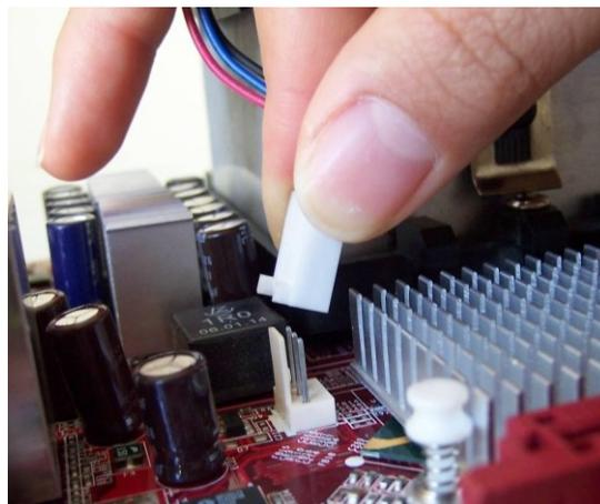
*Imagen 26: Conector del ventilador a la placa madre*
