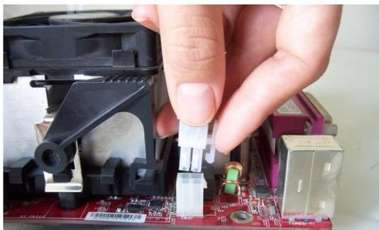
*Imagen 33: Instalación Conector P4 a la Mother Board*
