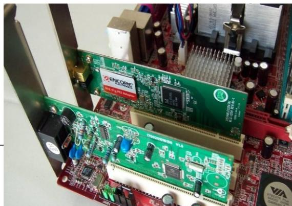
*Imagen 30: Tarjetas de Expansión Instaladas*
